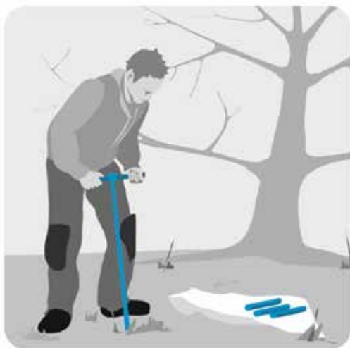
Rysunek 8. Pobieranie próbek gleby za pomocą: A. sondy glebowej; B. łopaty
