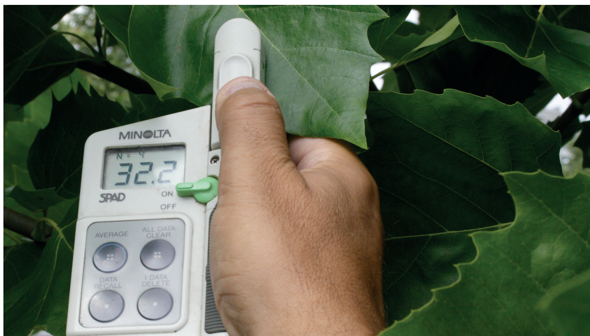
Ryc. 5. Pomiar względnej zawartości chlorofilu za pomocą miernika chlorofilu SPAD-502, firmy Konica-Minolta, Osaka, Japonia. (TS)
