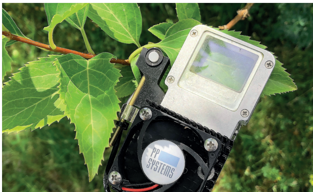
Ryc. 14. Pomiar intensywności fotosyntezy za pomocą kuwety liściowej systemu do pomiaru fotosyntezy Targas-1 firmy PP Systems Ltd., Amesbury, Massachusetts, USA. (TS)
