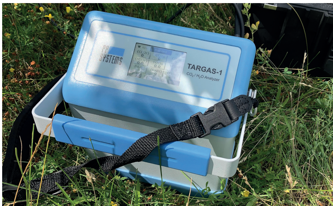
Ryc. 13. Konsola analizatora gazowego w podcierwieni (IRGA) typu Targas-1 firmy PP Systems Ltd., Amesbury, Massachusetts, USA. (TS)
