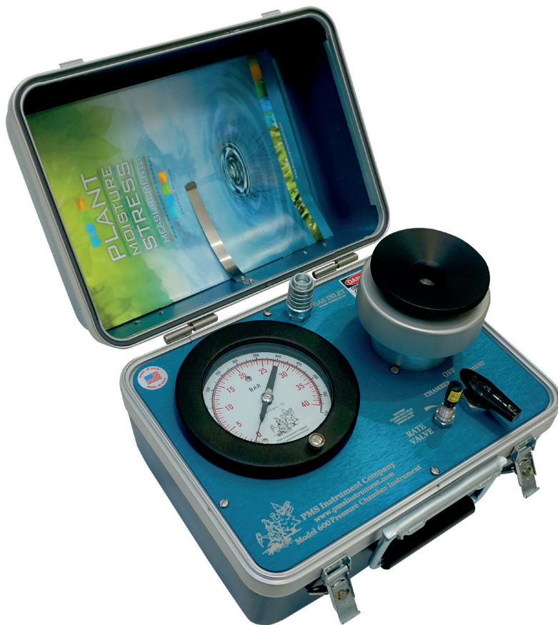
Ryc. 18. Zestaw komory ciśnieniowej, Model 615 firmy PMS Instrument Company, Albany, Oregon, USA jako przykład zestawu do pomiaru potencjału wody. Dzięki uprzejmości PMS Instrument Company, USA.
